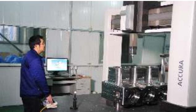
液力端三坐标检测
