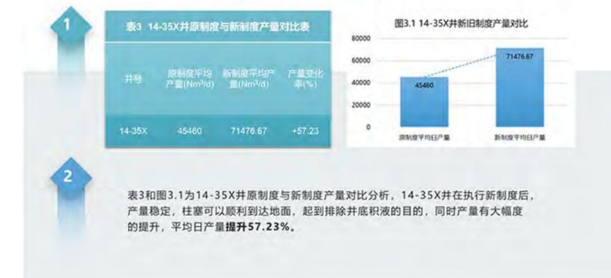
表3和图3.1为14-35X井原制度与新制度产量对比分析，14-35X井在执行新制度后，产量稳定，柱塞可以顺利到达地面，起到排除井底积液的目的，同时产量有大幅度的提升，平均日产量提升57.23%。
