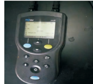
哈希HQ40d PH/电导率仪
