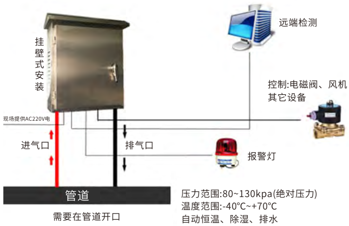
图2 固定式二氧化碳监测仪
